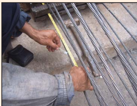
รูปที่ 4-13 การวัดค่าระยะยืดของ
