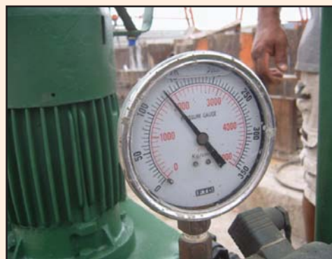
รูปที่ 4-12 การอ่านค่าแรงดึงลวด
