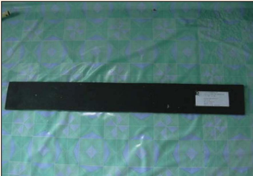
รูปที่ 2-11 ตัวอย่างแผ่นยางรองพื้นสะพานรองรับคานแบบแผ่นพื้น (Plank Girder)
