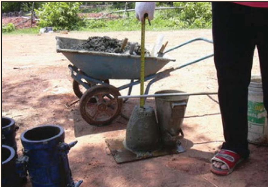
รูปที่ 2-8 การทดสอบค่ายุบตัวของคอนกรีต (Slump Test)
