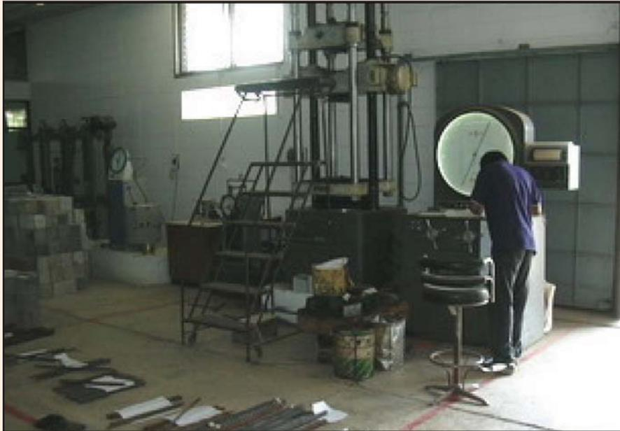
รูปที่ 2-6 เครื่องทดสอบความต้านทานแรงดึงวัสดุเหล็กเสริมและลวดอัดแรง
