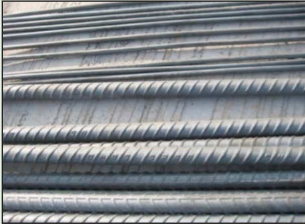
รูปที่ 3-17 เหล็กข้ออ้อย (Deformed Bar) และเหล็กเส้นกลม (Round Bar)
