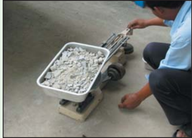
รูปที่ 3 - 6 แสดงวิธีแยกวัสดุโดยใช้เครื่องแบ่งแยกวัสดุ (Sample Splitter)
