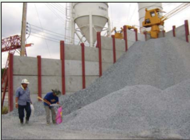
รูปที่ 3-16 การเก็บตัวอย่างวัสดุมวลรวมหยาบ (Coarse Aggregates)
