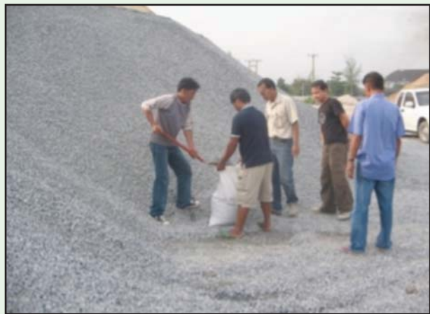
รูปที่ 3-16 การเก็บตัวอย่างวัสดุมวลรวมหยาบ (Coarse Aggregates)
