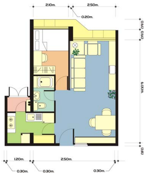
รูปที่ 8 ขนาดของห้องพักแบบ One bedroom modular flat
