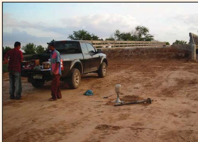
รูปที่ 5-5 การทดสอบความแน่นชั้นโครงสร้างทางที่รองรับ Approach Slab โดยการทำ Sand Cone Test
