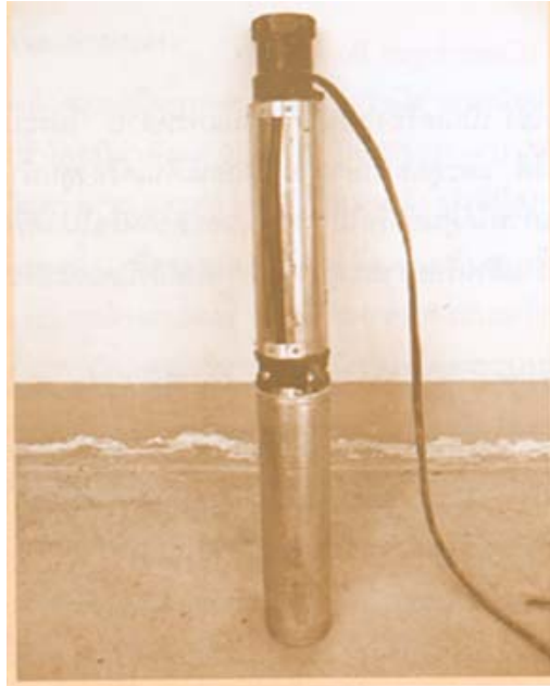
รูปที่ 31 เครื่องสูบน้ำบาดาลซบเมิซซิเบิล (Submersible Pump)
