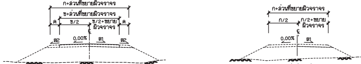
รูปตัดแสดงการยกระดับแบบ HALF CROWN
