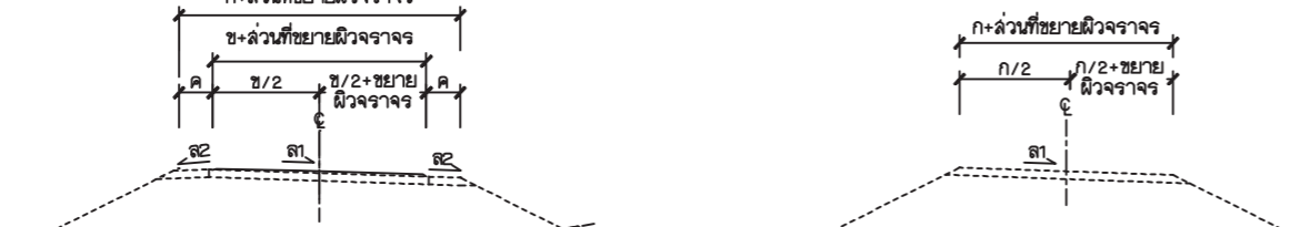
รูปตัดแสดงการยกระดับแบบ HALF CROWN
