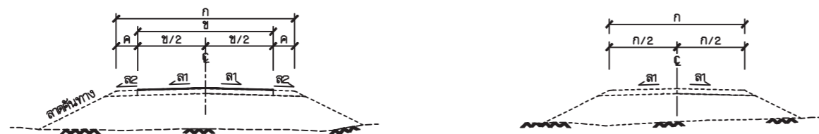
รูปแสดงการยกระดับผิวจราจรแบบ NORMAL CROWN
